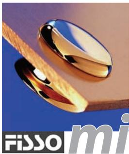
**IT** sistema a brugola con chiusura laterale di sicurezza per piccoli formati. fissare il distanziale a parete, appoggiarvi il pannello, inserire la testina attraverso il foro del pannello e fissarla grazie alla brugola laterale. per pannelli sottili, per targhe di piccolo formato e di poco spessore.
