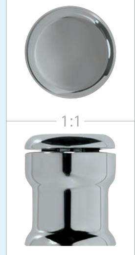
**IT sistema di fissaggio laterale con chiusura di sicurezza.** aggiustare il distanziale sul lato della lastra, posizionare la testina e fissarla con la brugola laterale. ideale in combinazione con il corner. **fissaggio:** fissaggio laterale con chiusura di sicurezza, per lastre senza fori. **materiale:** ottone con cromatura in oro lucido, cromo lucido o argento satinato. **distanza dalla parete:** 25mm. **spessore del pannello:** fino a 15mm.
